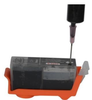
4. Trekk 10 ml blekk opp i sprøyta. Stikk sprøytespissen ned gjennom hullet du boret og injiser blekket forsiktig til det bakerste kammeret er fullt (blekk kommer opp). La patronen stå ca 1 minutt slik at blekket blir absorbert fra kammeret og inn i svampen. Etterfyll til bakkammeret er fullt.
