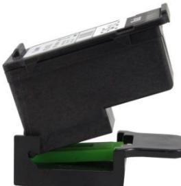
5. Sett patronen inn i den vedlagte refillklipsen. Stikk tuppen på den minste sprøyten (uten kanyle) inn i den grønne pakningen under på refillklipsen. Klem patronen ned mot den grønne pakningen, og trekk stempelet i sprøyten utover for å
