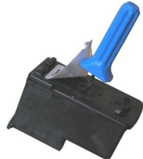
1. Sett patronen, med dysene ned, på et tykt lag med mykt tørkepapir. Loft etiketten på toppen av patronen delvis løs med hjelp av en kniv eller lignende. Under denne etiketten, midt på patronen, finner du påfyllingshullet. Du ser også en luftekanal som går i et sikk-sakk-mønster fra påfyllingshullet og til ytterkanten av etiketten.
